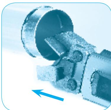
Ouvrir manuellement les 2 mâchoires de la pince. Insérer le tube aluminium dans la pince jusqu'en butée.
