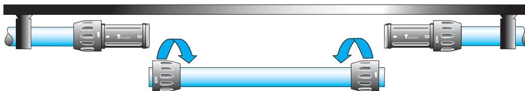
Dévissez les écrous situés du côté du tube à déplacer, les faire glisser le long de ce même tube. Puis ôter le tube.
